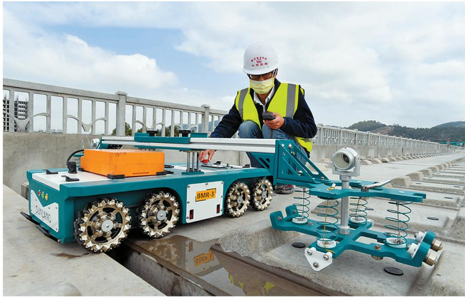
4月7日,中铁四局工程师耿海波在赣深铁路五标段无砟轨道试验段操作无砟轨道承载台检测机器人对
