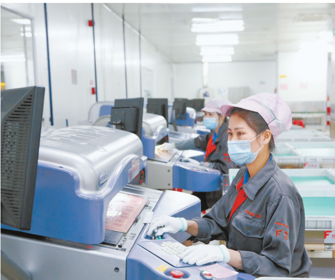
方正PCB厂AOI生产车间,工作人员进行作业。
