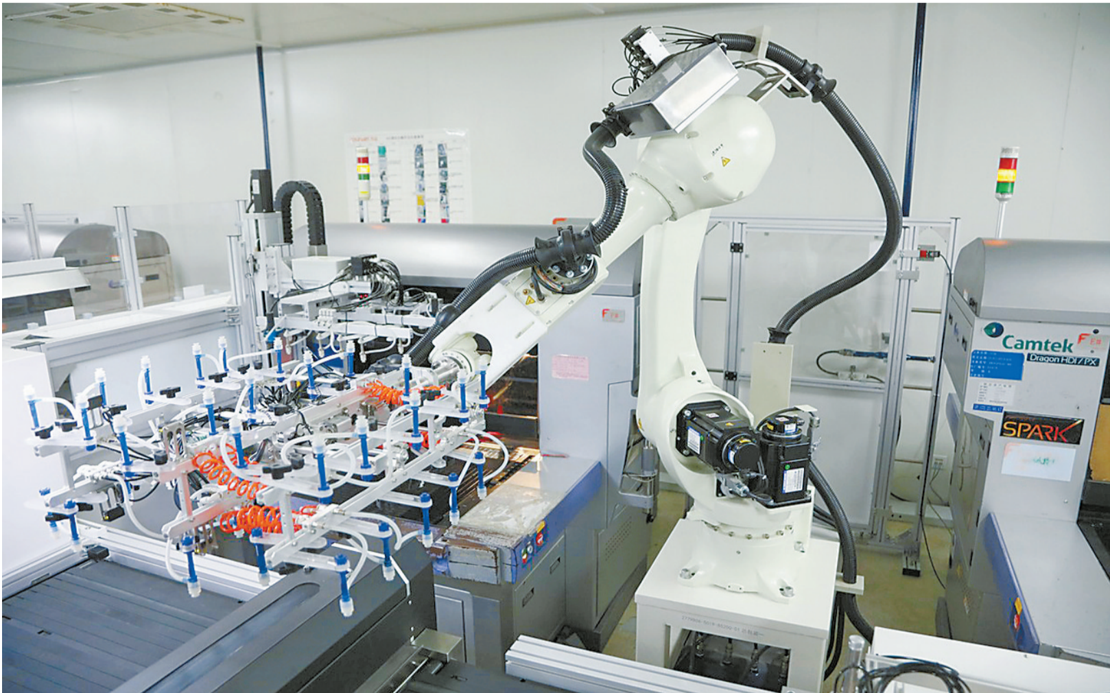
方正PCB厂AOI智能放板机器人进行作业。
