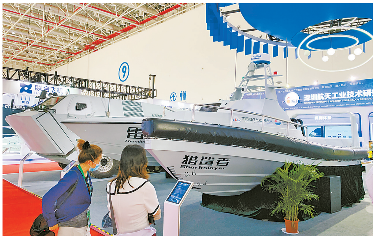
“猎鲨者”号警戒巡逻无人艇艇体长7.5米,艇宽2.5米,重达3吨。 本报记者 吴长赋 摄
