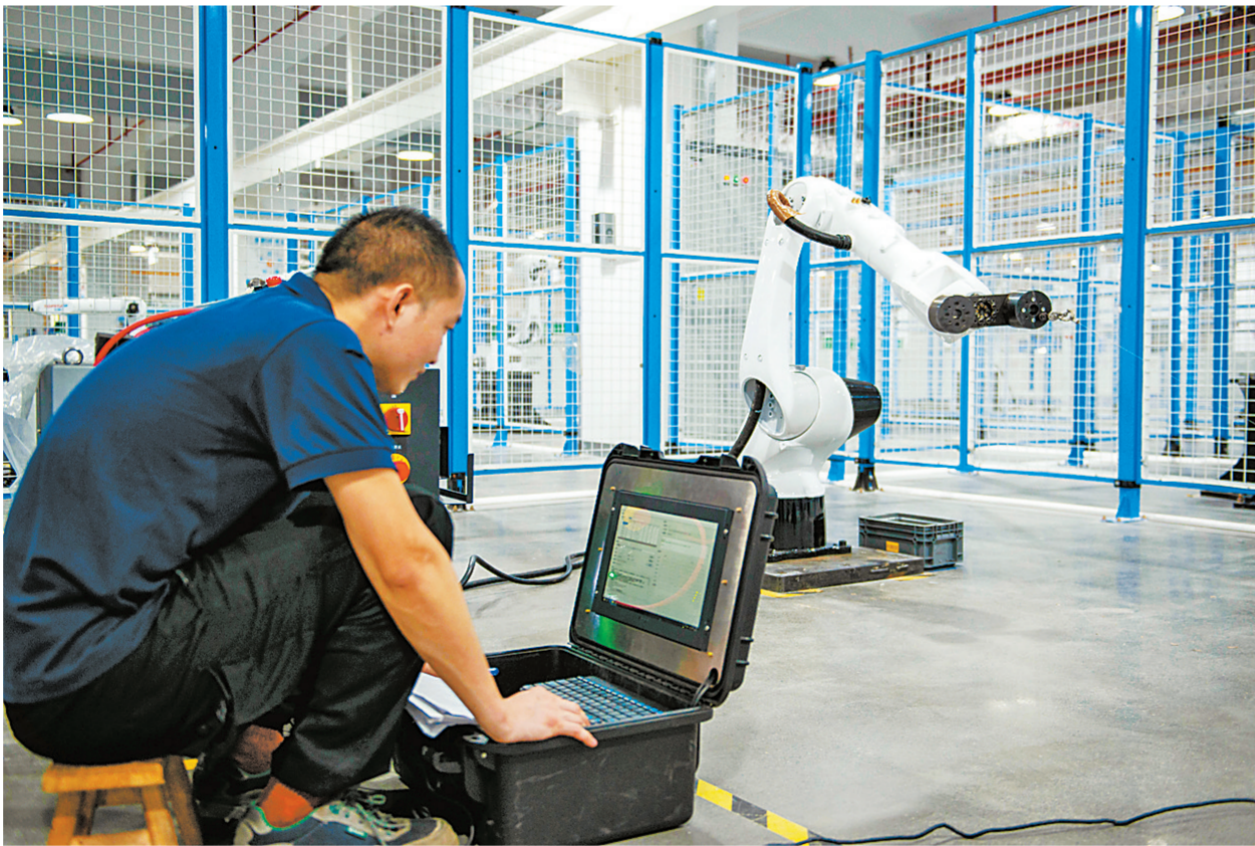
在广东拓斯达科技股份有限公司,工作人员对一台工业机器人进行绝对定位精度的校准。
