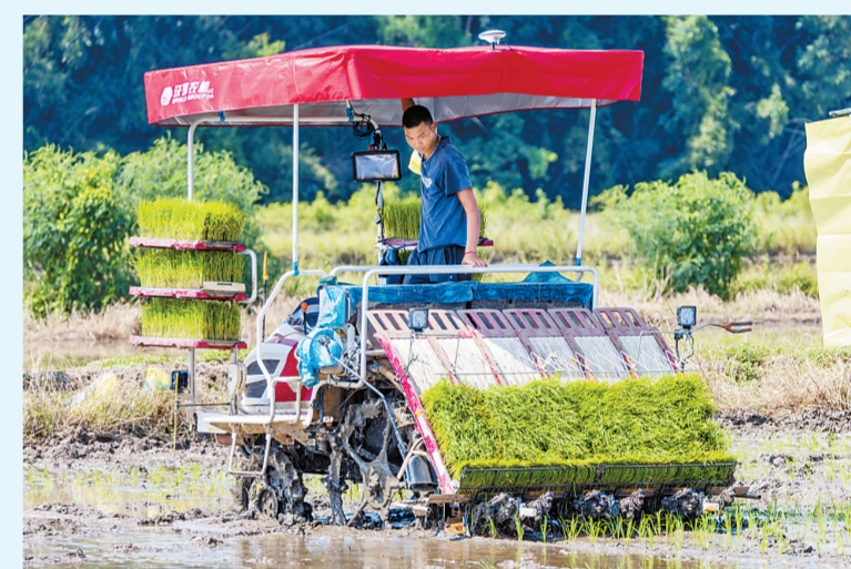
装载北斗导航的插秧机正在作业。
