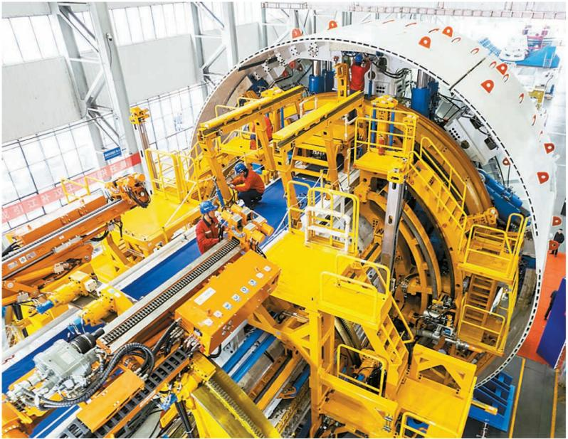
11月22日,在铁建重工长沙第一产业园,工人在调试“江汉新石器号”隧道掘进机(无人照机照片)。
