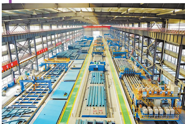
舟山公司钢箱梁单元智能生产线。
