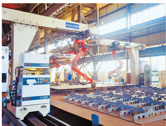
智能化车间内,机器人自动焊接单元。
